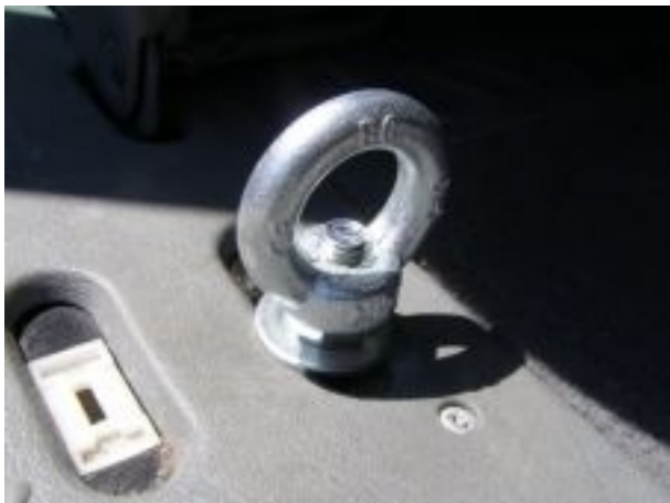
Wird mit 19-er Schlüssel verschraubt
