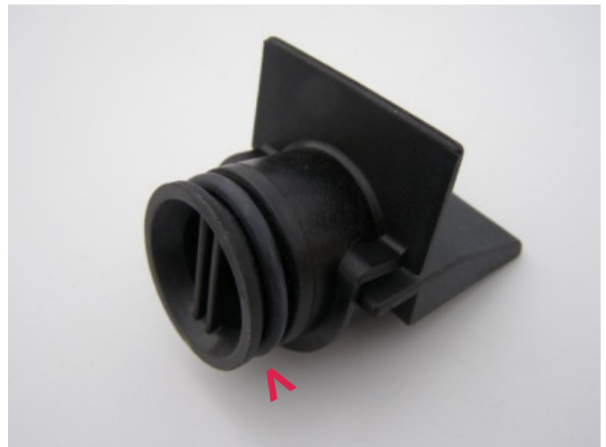
Ölverschluss (hier von einem Fiat 1.6 16V) - O-Ring s. Pfeil
