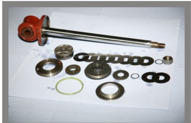
Ein Stoßdämpfer besteht aus vielen Einzelteilen.
