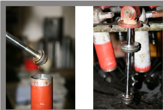
Der Stoßdämpfer wird total zerlegt, das Öl muss abtropfen.
